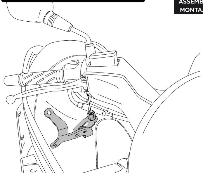
**MONTAR EL CONJUNTO SOPORTES APRETANDO PROGRESIVAMENTE LA TUERCA HEXAGONAL (ID.12) Y LA TUERCA AUTOBLOCANTE (ID.16)
