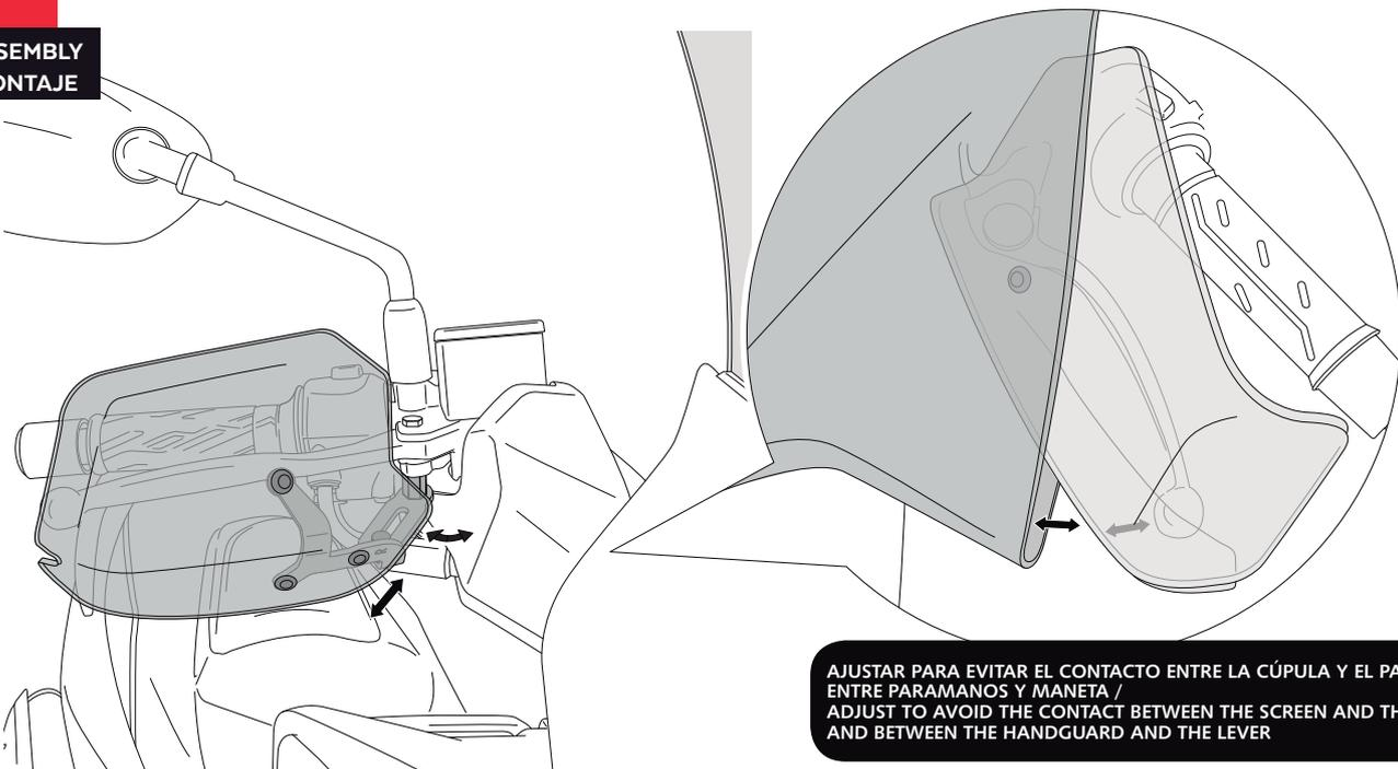
AJUSTAR PARA EVITAR EL CONTACTO ENTRE LA CÚPULA Y EL PARAMANOS, Y ENTRE PARAMANOS Y MANETA /
