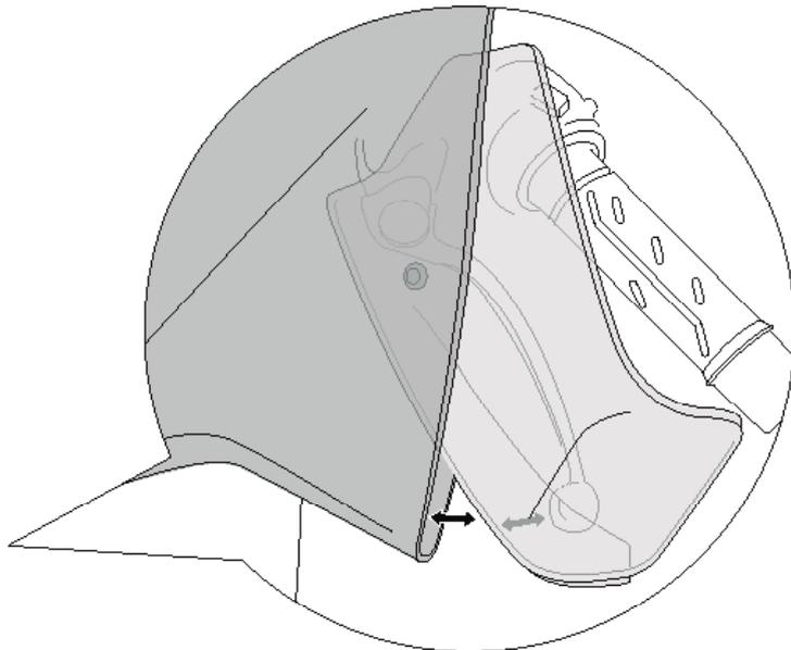
AJUSTAR PARA EVITAR EL CONTACTO ENTRE LA CÚPULA Y EL PARAMANOS, Y ENTRE PARAMANOS Y MANETA /
