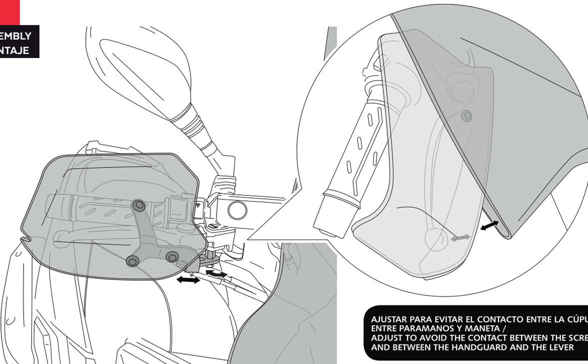
AJUSTAR PARA EVITAR EL CONTACTO ENTRE LA CÚPULA Y EL PARAMANOS, Y ENTRE PARAMANOS Y MANETA /
