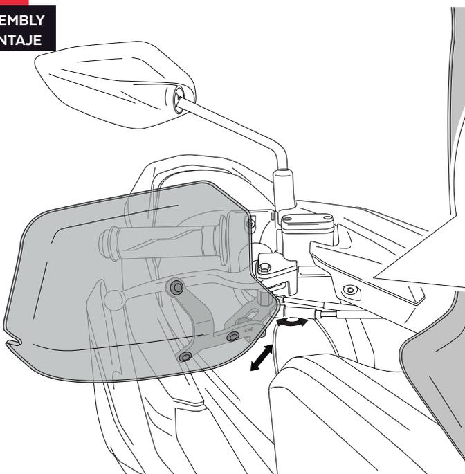
AJUSTAR PARA EVITAR EL CONTACTO ENTRE LA CÚPULA Y EL PARAMANOS, Y ENTRE PARAMANOS Y MANETA /
