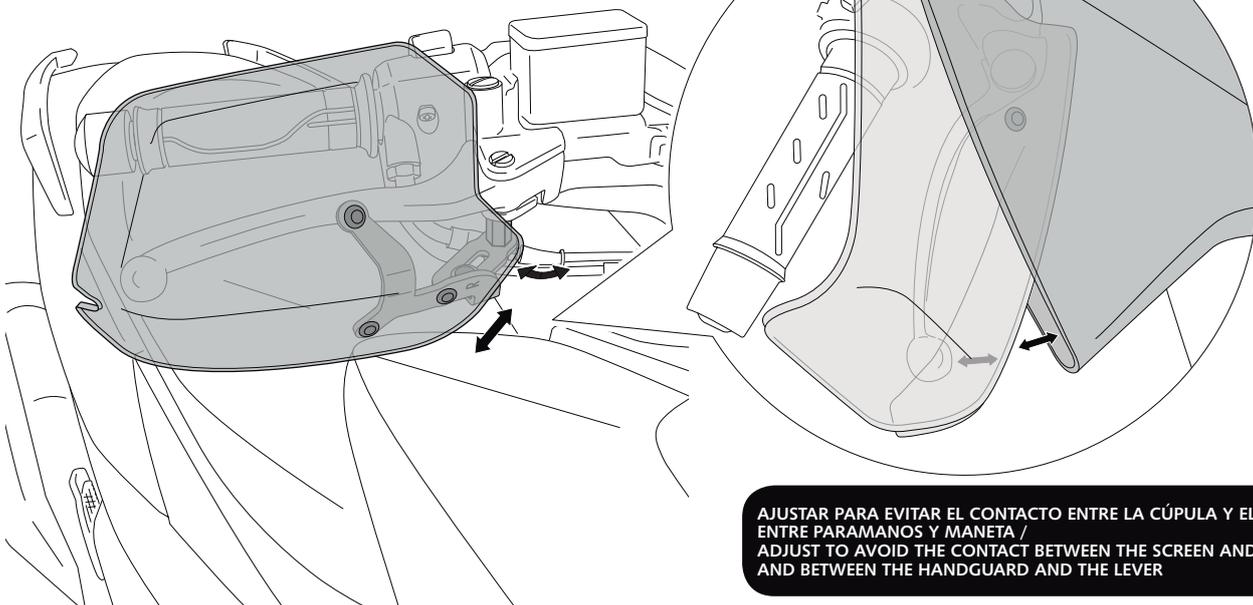
AJUSTAR PARA EVITAR EL CONTACTO ENTRE LA CÚPULA Y EL PARAMANOS, Y ENTRE PARAMANOS Y MANETA /
