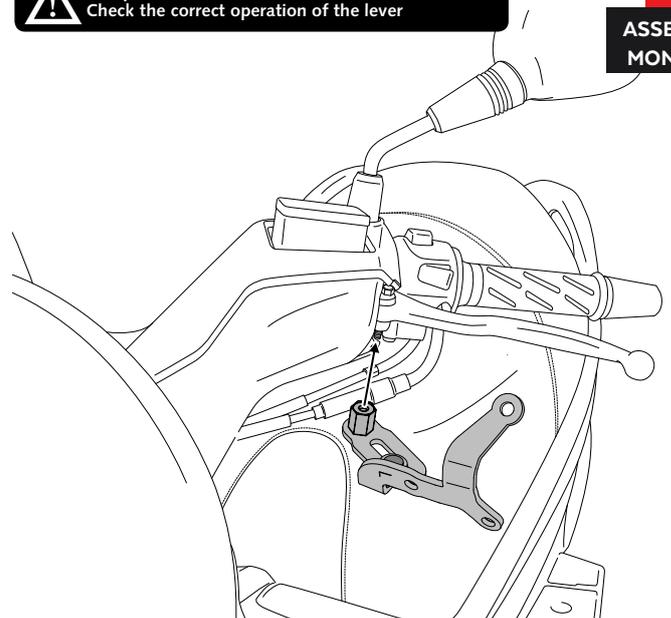
**MONTAR EL CONJUNTO SOPORTES APRETANDO PROGRESIVAMENTE LA TUERCA HEXAGONAL (ID.12) Y LA TUERCA AUTOBLOCANTE (ID.16)
