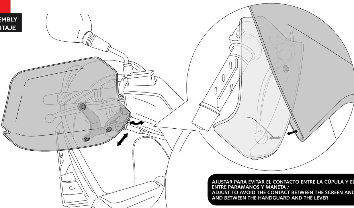
AJUSTAR PARA EVITAR EL CONTACTO ENTRE LA CÚPULA Y EL PARAMANOS, Y ENTRE PARAMANOS Y MANETA /
