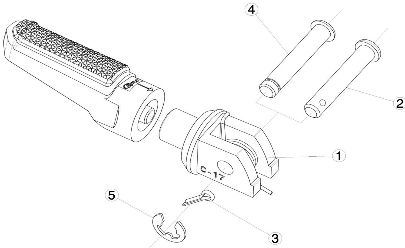
**YAMAHA YZF R6 '02> YZF R1 '04-'06** el eje (2) de la estribera está remachado al soporte de la moto. Para estos casos se entrega el eje (4) y el anillo (5) de seguridad para substituir al eje que se ha cortado. El lado que no va remachado se aprovecha el eje (2) i el pasador original (3)
